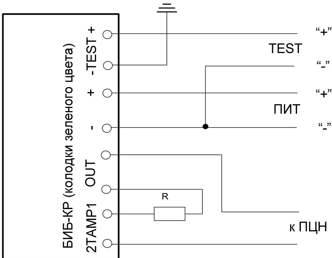
Рисунок 2 - Схема подключения искроопасных цепей
