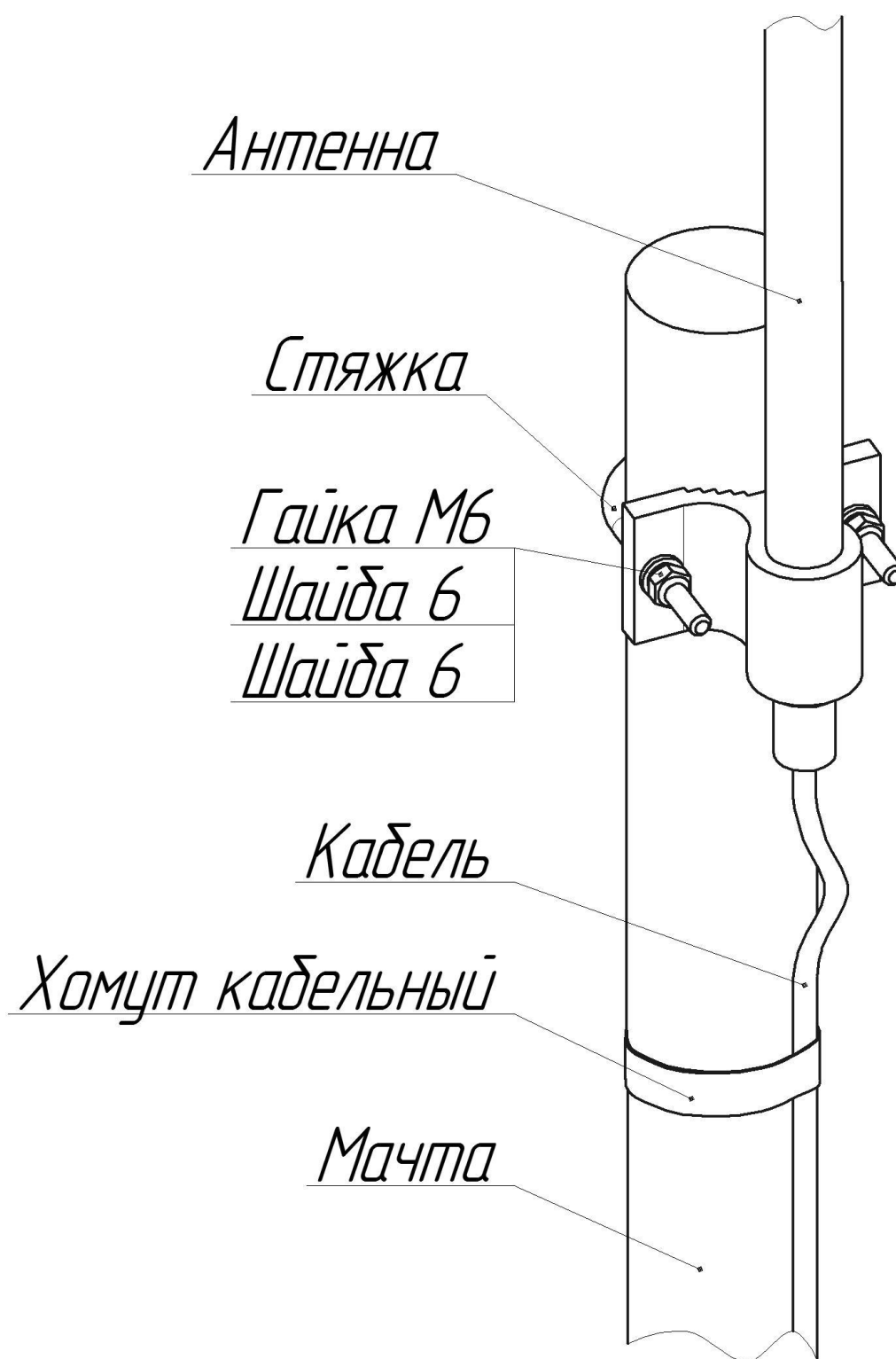
Рисунок 1 – Установка Комплекта Антенны АКМ-868 на мачте
