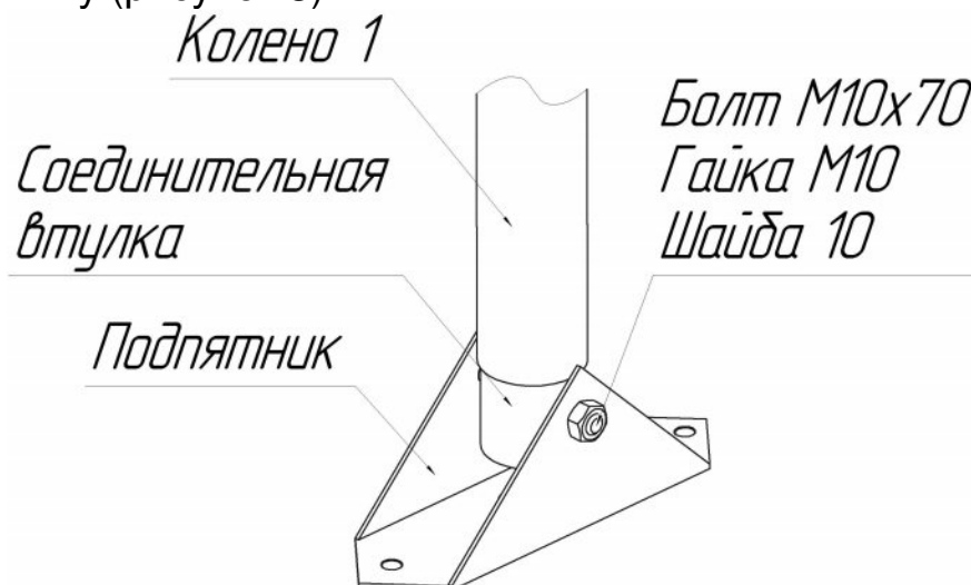
Рисунок 3 – Соединение подпятника с коленом
