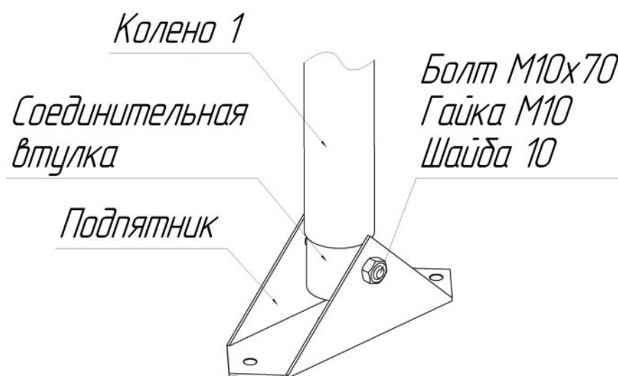
Рисунок 3 – Соединение подпятника с коленом
